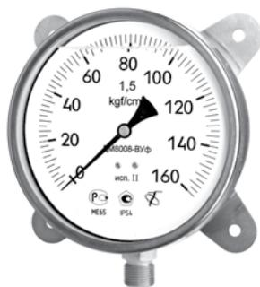
**ПРЕДНАЗНАЧЕНЫ ДЛЯ ИЗМЕРЕНИЯ ИЗБЫТОЧНОГО И ВАКУУММЕТРИЧЕСКОГО ДАВЛЕНИЯ НЕАГРЕССИВНЫХ, НЕКРИСТАЛЛИЗУЮЩИХСЯ ЖИДКОСТЕЙ, ПАРА И ГАЗА, В Т. Ч. КИСЛОРОДА, ХЛАДОНА.**
