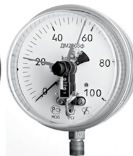
**ПРЕДНАЗНАЧЕНЫ ДЛЯ ИЗМЕРЕНИЯ ИЗБЫТОЧНОГО И ВАКУУМЕТРИЧЕСКОГО ДАВЛЕНИЯ НЕКРИСТАЛЛИЗУЮЩИХСЯ ЖИДКОСТЕЙ, ГАЗОВ И ПАРОВ, НЕАГРЕССИВНЫХ К МАТЕРИАЛАМ ДЕТАЛЕЙ, КОНТАКТИРУЮЩИХ С ИЗМЕРЯЕМОЙ СРЕДОЙ, В Т.Ч. КИСЛОРОДА, И ЗАМЫКАНИЯ ИЛИ РАЗМЫКАНИЯ ЭЛЕКТРИЧЕСКИХ ЦЕПЕЙ ПРИ ДОСТИЖЕНИИ ЗАДАННОГО ПРЕДЕЛА ДАВЛЕНИЯ.**
