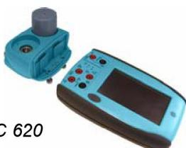
**База модулей давления MC 620 (см. в этом руководстве пользователя):** Прикрепляется к устройству калибровки DPI 620 для получения полнофункционального индикатора давления. Чтобы измерить и отобразить пневматическое или гидравлическое давление, можно подсоединить два взаимозаменяемых модуля давления одновременно.
