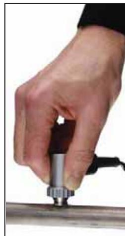
Измерение толщины стенки
