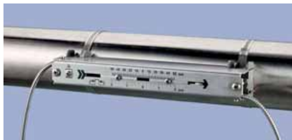
Накладные датчики в монтажном кожухе
