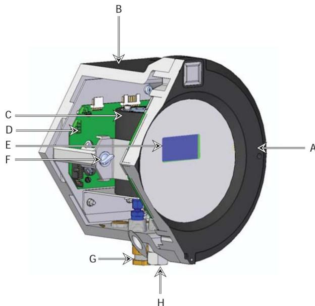
**Рис. 28** Разрез прибора XTR601 с изображением основных компонентов
