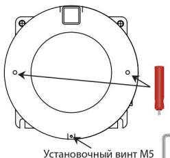
**Рис. 29 Снятие крышки с прибора ХТР601**
