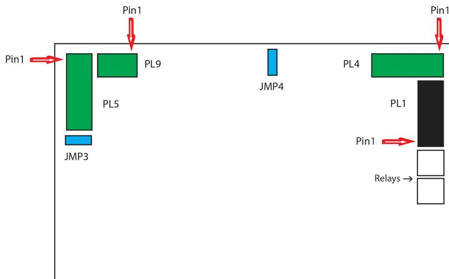
**Рис. 31 Расположение клеммных колодок**
