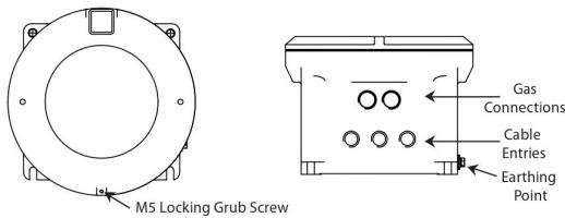
**Рис. 30 Кабельные вводы прибора ХТР601**
