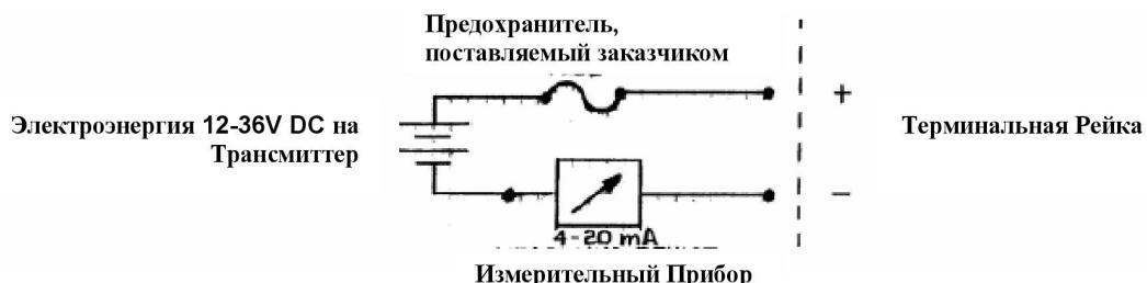
**Осторожно:** Для обеспечения надлежащего заземления, подсоедините выходной сигнал 4-20mA к внешнему устройству (PLC, DCS, и т.п.) до наладки нуля и диапазона.
