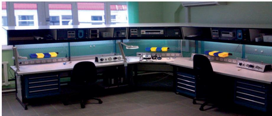
Рис. 1. Стенд для поверки/калибровки/ремонта СИ давления, температуры, электрических сигналов РУП «ПО Белоруснефть», Белорусский газоперерабатывающий завод
