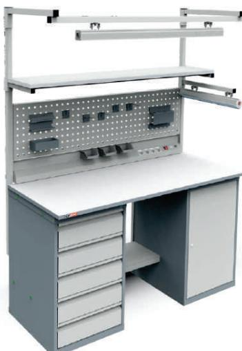
В зависимости от типа столешницы стол серии «Монолит» выдерживает нагрузки от 350 до 500 кг распределенного веса. Жесткая конструкция стола с опорой на тумбы не позволяет регулировать высоту расположения столешницы. Столы серии «Монолит» могут быть укомплектованы всеми стандартными опциями и комплектующими серии СТАНДАРТ.
