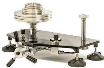
Предназначен для поверки и калибровки средств измерения избыточного давления: калибраторов давления, измерительных преобразователей давления (датчиков), образцовых и технических манометров, грузопоршневых манометров, классов точности 0,008 и грубее в диапазоне от -0,003 до 16 МПа.
