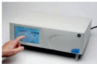
Точное задание, измерение и поддержание абрс., изб. и баром. давления в составе испытательных стендов. Применяется при производстве датчиков давления и манометров, в исследовательских и конструкторских лабораториях, в лабораториях по поверке и ремонту средств измерения давления.
