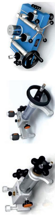
Высококачественные помпы (пресссы) с тонкой настройкой давления. Для поддержания стабильного давления в процессе калибровки/проверки, помпы серии ADT сконструированы таким образом, чтобы нивелировать влияние температуры внешней среды. Специально разработанный запорный клапан помп позволяет поддерживать стабильное давление на всем протяжении процедуры калибровки/проверки.
