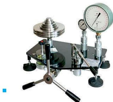
Предназначен для поверки и калибровки средств измерений избыточного давления: измерительных преобразователей давления (датчиков), образцовых и технических манометров, классов точности 0,075 и грубее в диапазоне от 0,04 до 60 МПа.
